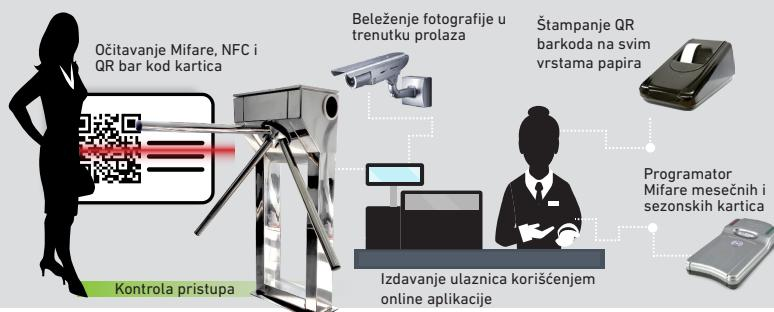
Osnovno sistemsко rešenje koje objedinjuje kontrolu pristupa i bletski sistem koji funkcioniše bez potrebe za stalnom vezom sa internetom i omogućava osnovnu kontrolu rada sistema, odnosno karata prodatih u biletarnici. Sistem koristi RFID i NFC beskontaktnе kartice i QR barkod karte. U cilju zadovoljavanja posebnih bezbednosnih zahteva, ponuđena je opcija integracije i IP kamere koja beleži fotografiju u trenutku prijavljivanja kartice.
